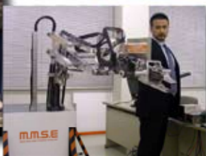
パワーエフェクタ Power Effector 多自由度の上肢パワー増幅
