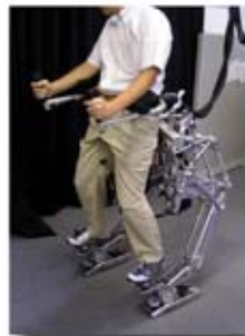
パワーペダル Power Pedals 下肢パワー増幅による歩行の実現
