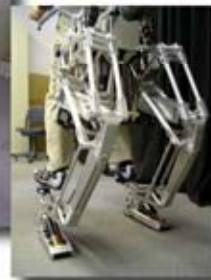
パワーペダル Power Pedals 下肢パワー増幅による歩行の実現
